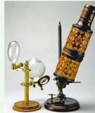
Рис. 46. Микроскоп Р. Гука
