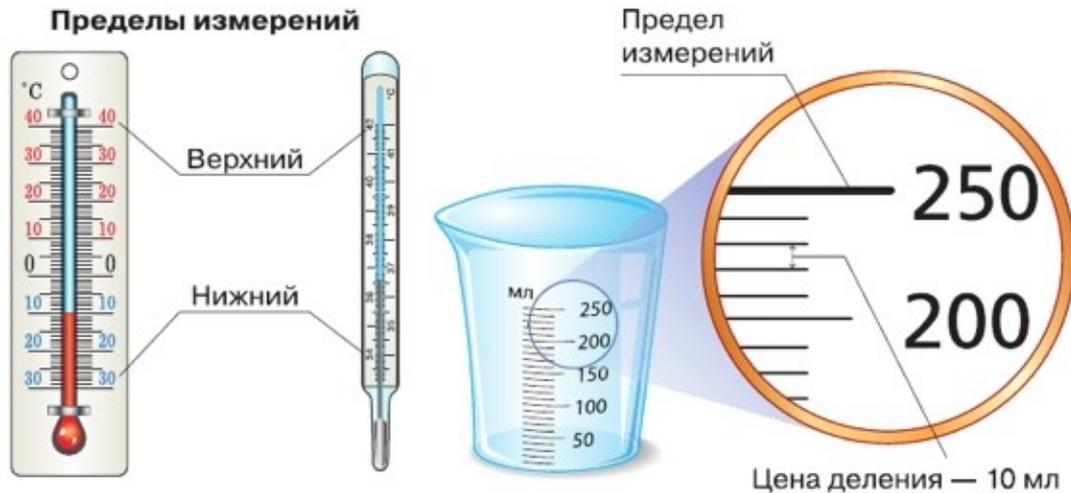
Рис. 22. Предел измерения и цена деления шкал измерительных приборов
